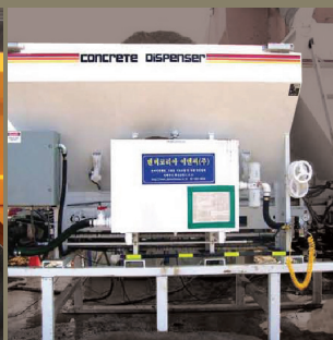
Batch Plant (주입재 배합)
